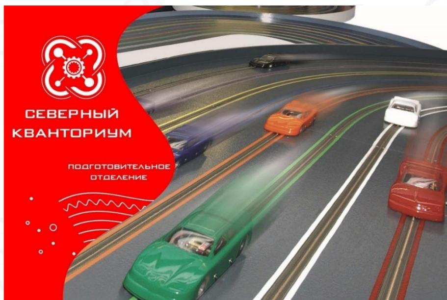
Трассовый моделизм – это разновидность автомоделльного спорта. Трассовая модель автомобиля – модель с внешним питанием, движется по специальной трассе, направление модели задает паз в трассе, а питание модель получает от токонесущих шин. Спортсмен управляет только скоростью модели при помощи специального пульта.
