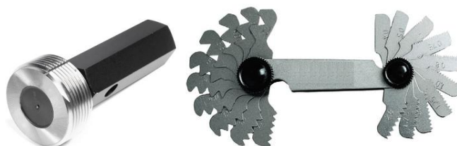
Рисунок 9 – Пример калибр-пробки и резьбомеров
